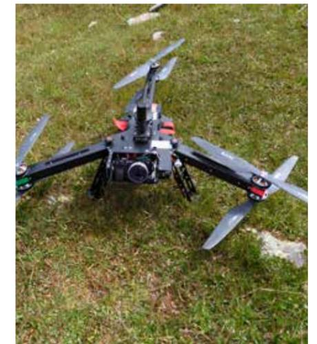
Luftbildaufnahme am Tschadinhorn Blockgletscher mit der Drohne twinFold GEO, einem Y6 Hexacopter
