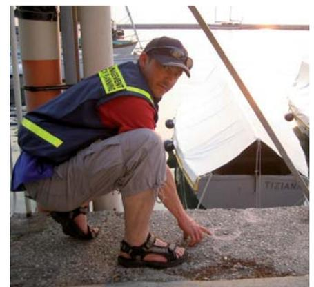
Ing. MBA Stefan Thaler, Höhenbolzen am Molo Sartorio in Triest (im Boden eingelassen) mit der eigentlichen Messanlage des Adria-Wasserstandes (Standrohr im Bild links)
