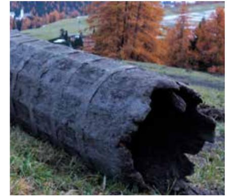
Durch 270 Stück dieser hölzernen Druckrohre wurde Wasser aus dem Dorferbach zur Turbine in „Weidach“ geleitet.
